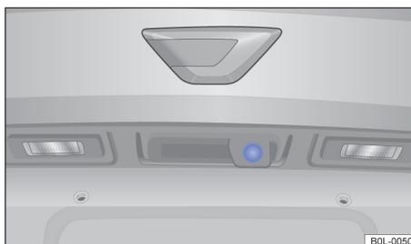
Рисунок 156. На двери багажника: камера обзора заднего вида ▶
