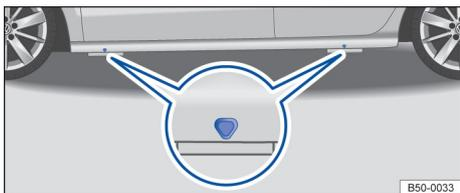
Рисунок 152. Точка опоры автомобильного домкрата
