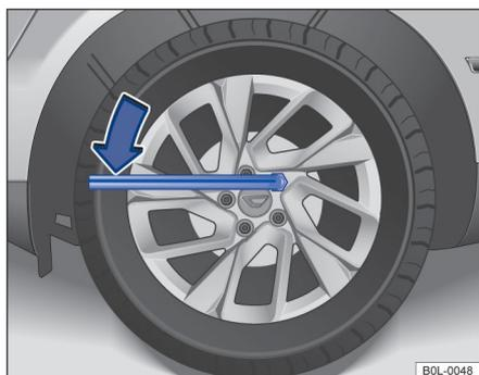
Рисунок 151. Замена колеса: откручивание колесных болтов
