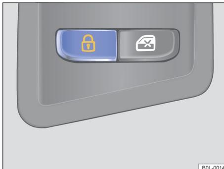
Рисунок 41. На двери водителя: кнопка управления центральным замком
