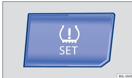
Рисунок 142. Центральная консоль: кнопка контроля давления в шинах
