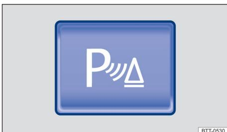
Рисунок 98. Верхняя часть центральной консоли: кнопка включения или выключения парковочного радара (Схематическое изображение)
