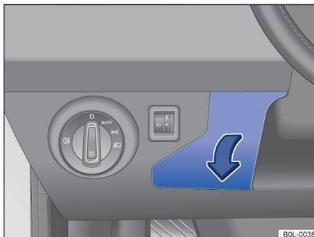
Рисунок 122. Приборная панель со стороны водителя: крышка блока предохранителей
